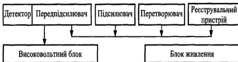
Рис.1. Структурна схема установки реєстрації іонізуючого випромінювання
